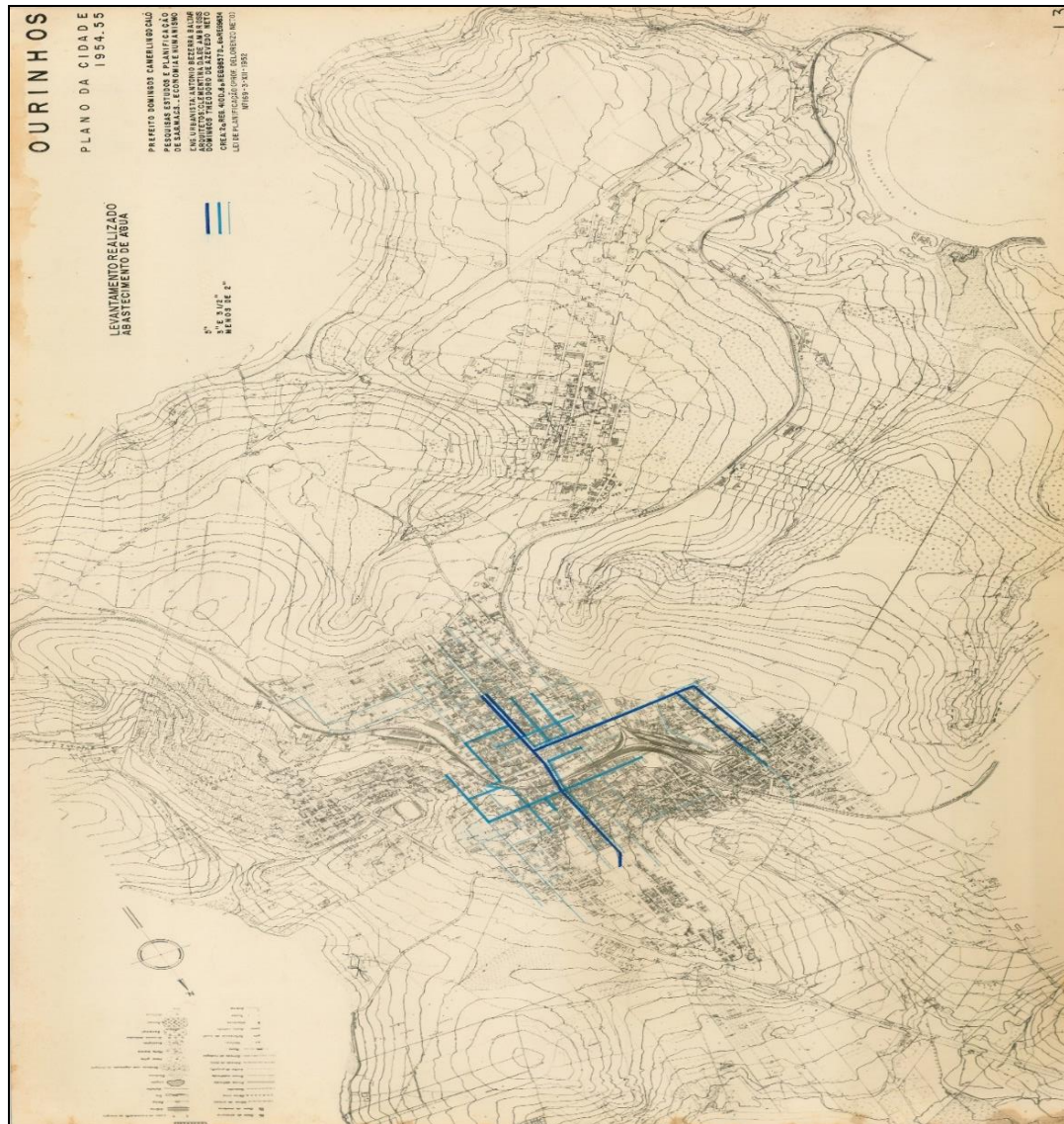
Figura 4 – Abastecimento de água urbana em Ourinhos, 1954-1955
