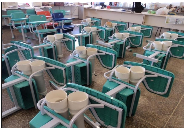
Figura 7 – Teste de vazamento do pluviômetro de PVC Fonte: SOUSA, R. R., 2016.
