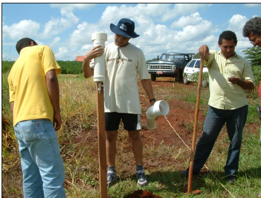
Figura 10 – Processo de instalação pluviômetro de baixo custo na estação Fonte: SOUSA, R. R., 2016.
