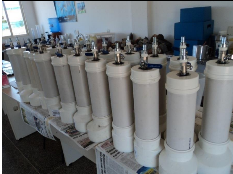
Figura 6 – Cortes e colagem do pluviômetro de PVC Fonte: SOUSA, R. R., 2016.
