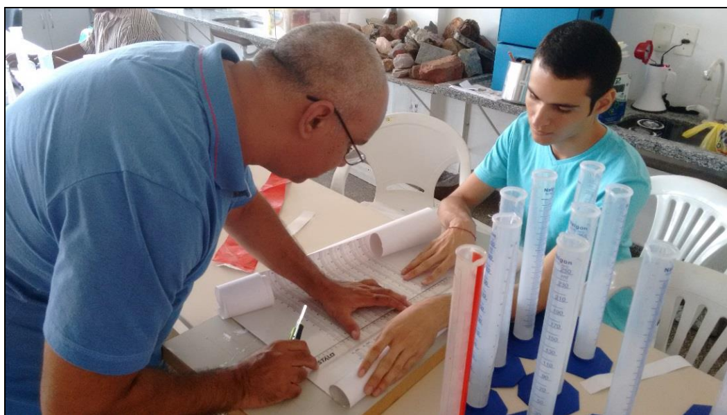
Figura 8 – Processo de colagem da graduação de 250 ml para 15 mm Fonte: SOUSA, R. R., 2016.
