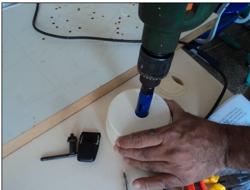
Figura 4 – Início da confecção do pluviômetro de PVC Fonte: SOUSA, R. R., 2016.
