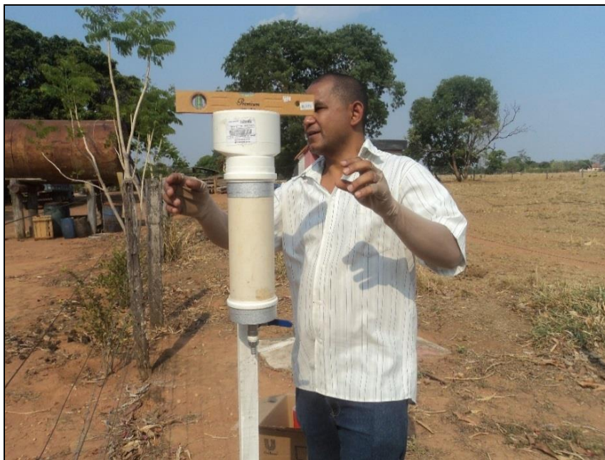
Figura 13 – Instalação do pluviômetro de PVC Fonte: SOUSA, R. R., 2016.
