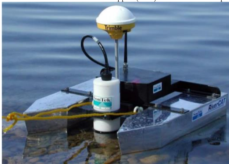
Figura 3 – Perfilador de corrientes acústico Doppler (ADP) utilizado en las campañas de aforo
