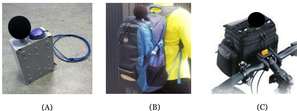
Fig. 3 - Equipamentos desenvolvidos pelo grupo de pesquisa INTEC – Acoustics (Universidade de Gante-Bélgica): (A) Equipamento de coleta de dados contínuos; (B) Equipamento posicionado para coleta de dados por modo à Pé; (C) Equipamento posicionado para coleta de dados por modo ciclovário.
